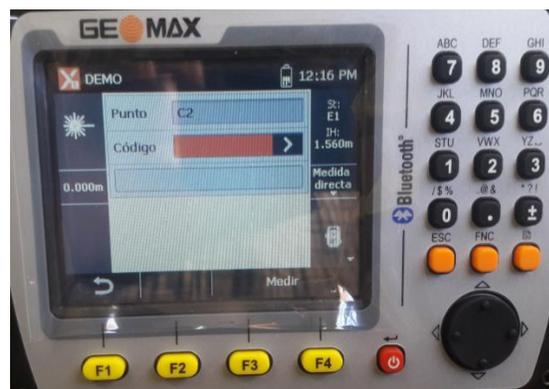
2.- "Posición Conocida" y "Orientación por azimut". Clic en "Siguiente" e ingresamos los parámetros de la Estación como tal: Nombre, Altura Instrumental, Código, Coordenadas. Clic en "Siguiente".
