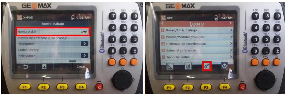
Antes que nada, configuraremos el trabajo realizando clic en los "Engranajes" que se encuentran en la parte inferior de la pantalla, verificaremos: "Unidades", "Decimales", "Coordenadas", "Tolerancias de Levantamiento y Replanteo" y "Opciones varias". Parámetros a criterio de cada Usuario.
